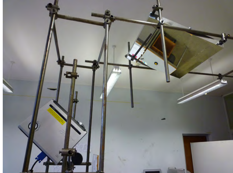
Der Beamer muss genau in die Mitte des Spiegels projizieren, damit das Bild möglichst wenig Verzerrungen aufweist.
