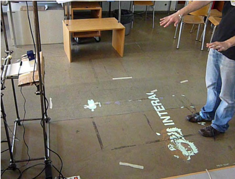
Erstes Zweihand-Tracking: mit der linken und rechten Hand werden unterschiedliche Inhalte gesteuert
