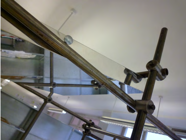
Montage des Spiegels. Dieser liegt verschiebbar und drehbar auf.
