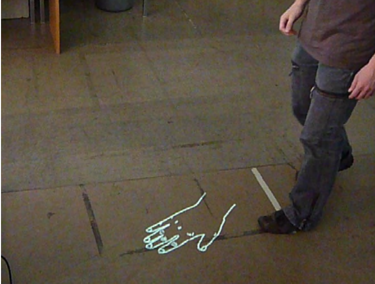
Entwurf für den Idle-Mode (wenn nichts läuft): eine Hand am Boden wandert mit der Position des Benutzers mit und soll zur Interaktion mit den Händen auffordern
