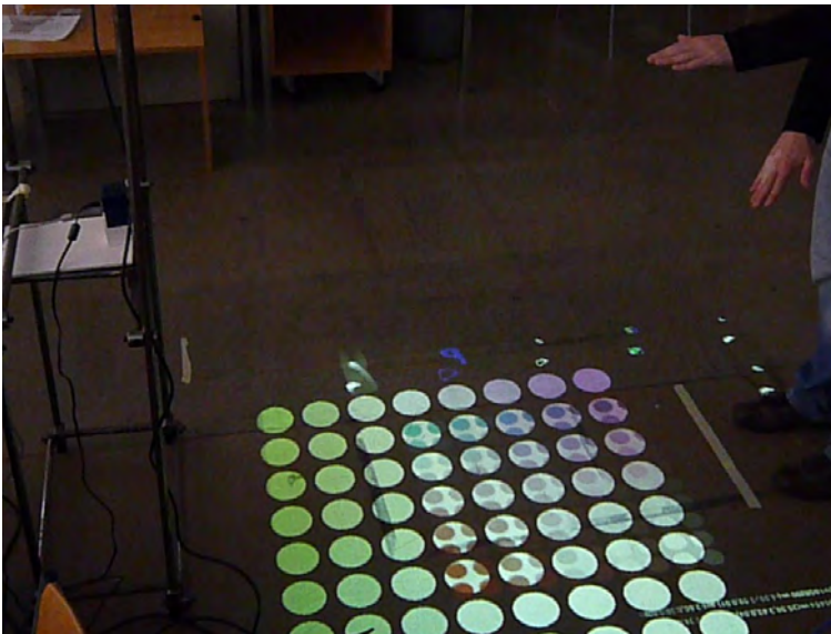
Additive Farbmischung (Lichtmischung) durch das Übereinanderlegen gefärbter Farbraster
