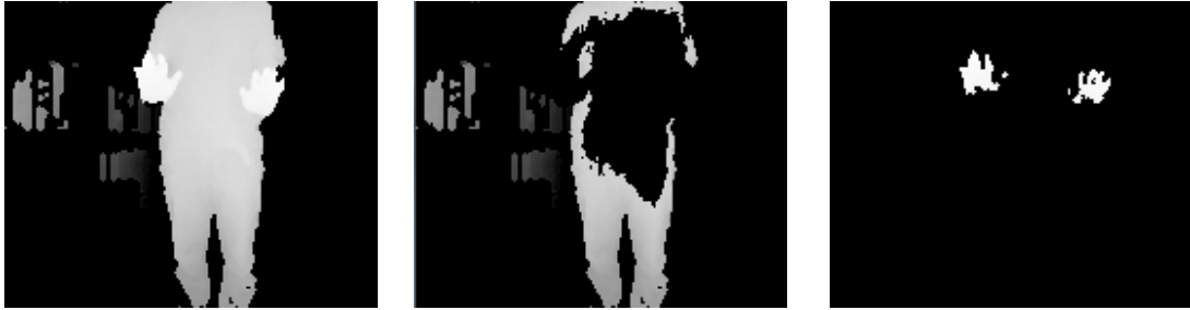
Abbildung 5: Distanzbild (Graustufen 2D), Hintergrunde (Körper), Vordergrunde (Hände)
