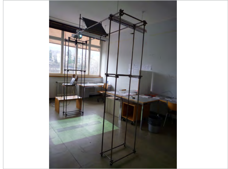
Das erste Gerüst, mit Beamer und Projektionsspiegel
