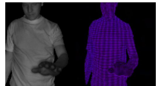
Abbildung 4: Aus der Distanzinformation berechnetes 2D Graustufenbild und 3D Punktwolke
