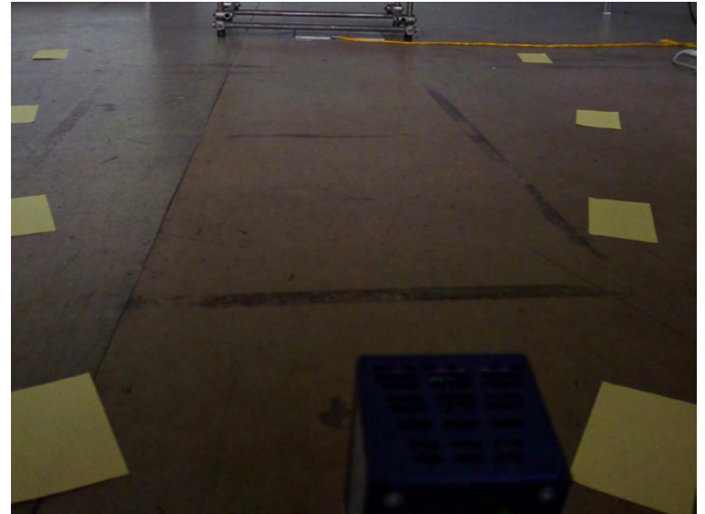
Die Kamera befindet sich in der Nähe des Bodens, um eine maximale Handfläche zu erkennen. Allerdings ist das Field of View (FOV) stark eingeschränkt (gelbe Zettel)
