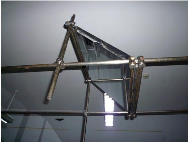
Der Spiegel wurde im ersten Experiment in einem Winkel von 45° aufgestellt um Verzerrungen zu vermeiden.
