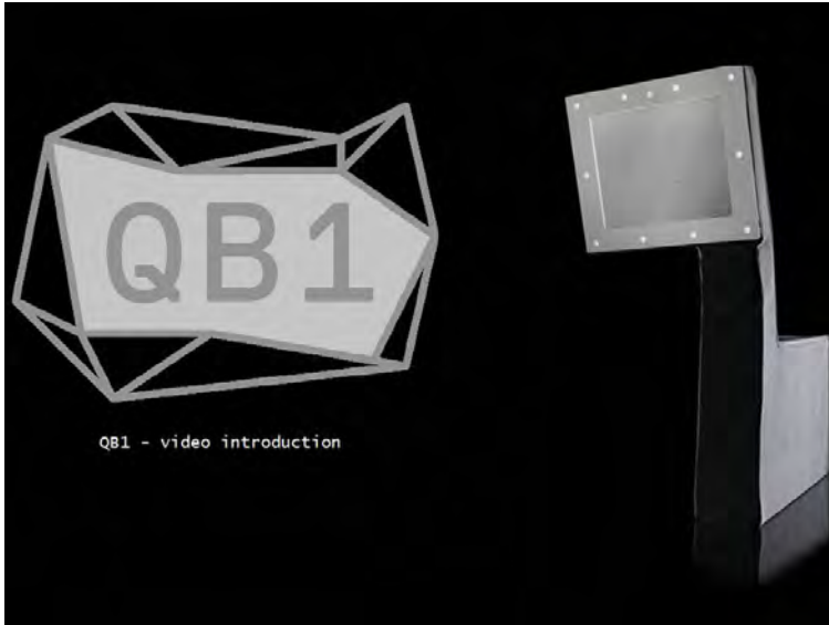
QB1: Roboter richtet den Bildschirm nach Benutzer aus und reagiert auf Gesten
