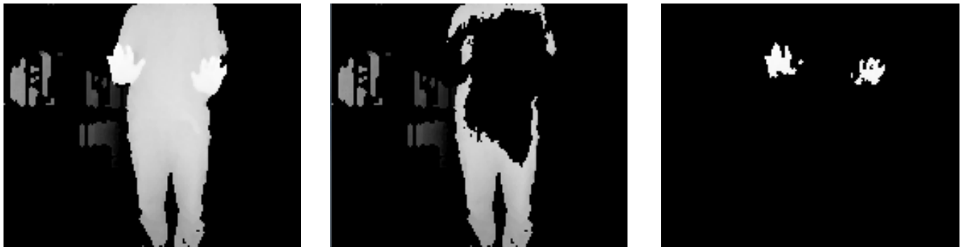
Abbildung 5: Distanzbild (Graustufen 2D), Hintergrundebene (Körper), Vordergrundebene (Hände)
