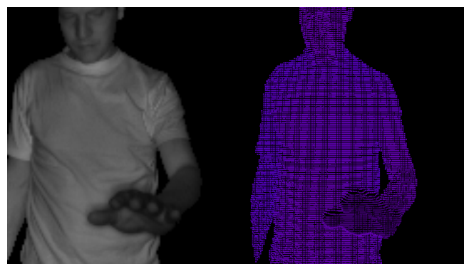
Abbildung 4: Aus der Distanzinformation berechnetes 2D Graustufenbild und 3D Punktwolke
